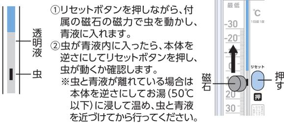
①リセットボタンを押しながら、付属の磁石の磁力で虫を動かし、青液に入れます。
