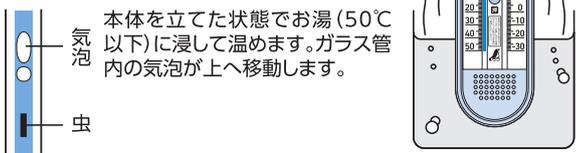
本体を立てた状態で湯 (50℃以下) に浸して温めます。ガラス管内の気泡が上へ移動します。
