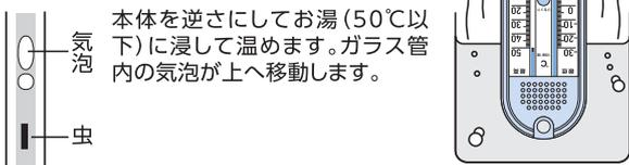
本体を逆さにして湯 (50℃以下) に浸して温めます。ガラス管内の気泡が上へ移動します。
